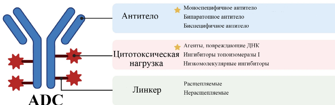
Рисунок 1. Структура конъюгата антитело – токсин. ADC состоит из трех основных компонентов: моноклонального антитела для специфического взаимодействия с рецепторами на поверхности опухолевых клеток, цитотоксического вещества для уничтожения опухолевых клеток и химического линкера, регулирующего высвобождение лекарственного средства, адаптировано из [8] (CC BY-SA 4.0).
